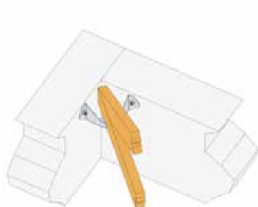
Estribo para ángulo SAMI instalado con CSA
