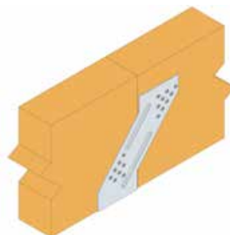
Estribo para ménsulas SCR instalado con CSA
