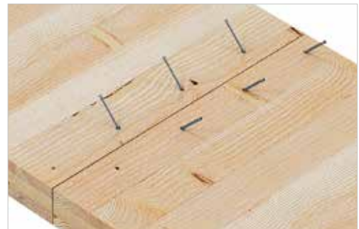
Unión de tablero de CLT sobre tablero de CLT con tornillos SWD cruzados
