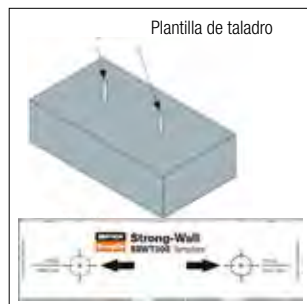
Etapa 1 Instale las varillas roscadas
